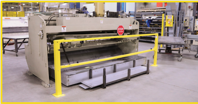
Protection des machines/des équipements
